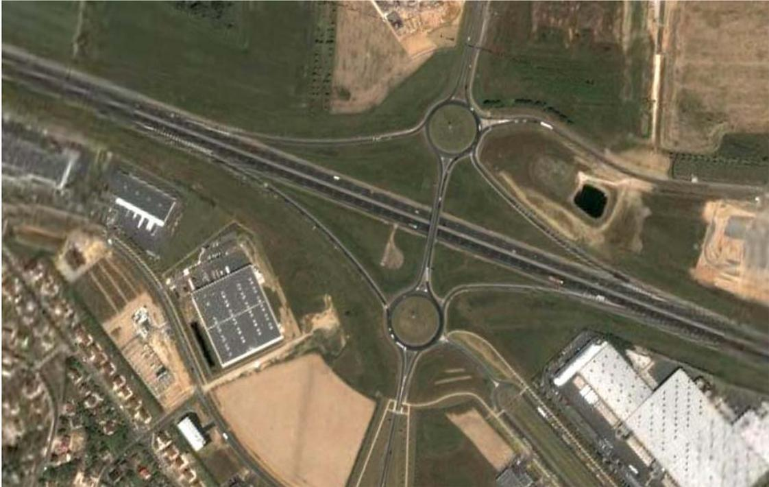
Figura A 13/n .67 Intersezione completa con radiali minori. Esempio 5.
