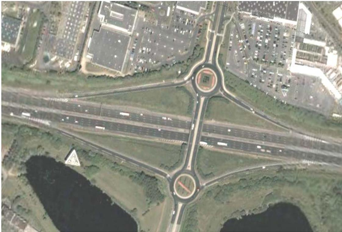
Figura A 13/n 63 Intersezione completa con radiali minori. Esempio 1.
