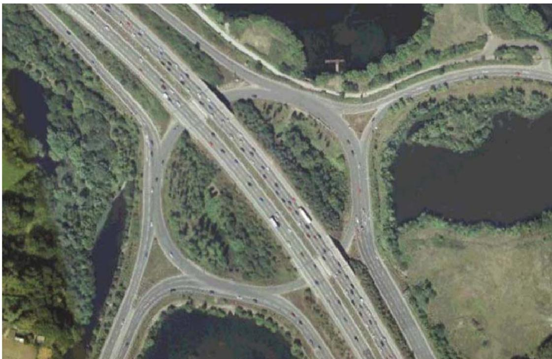
Figura A 13/n. 64 Intersezione completa con radiali minori. Esempio 2.
