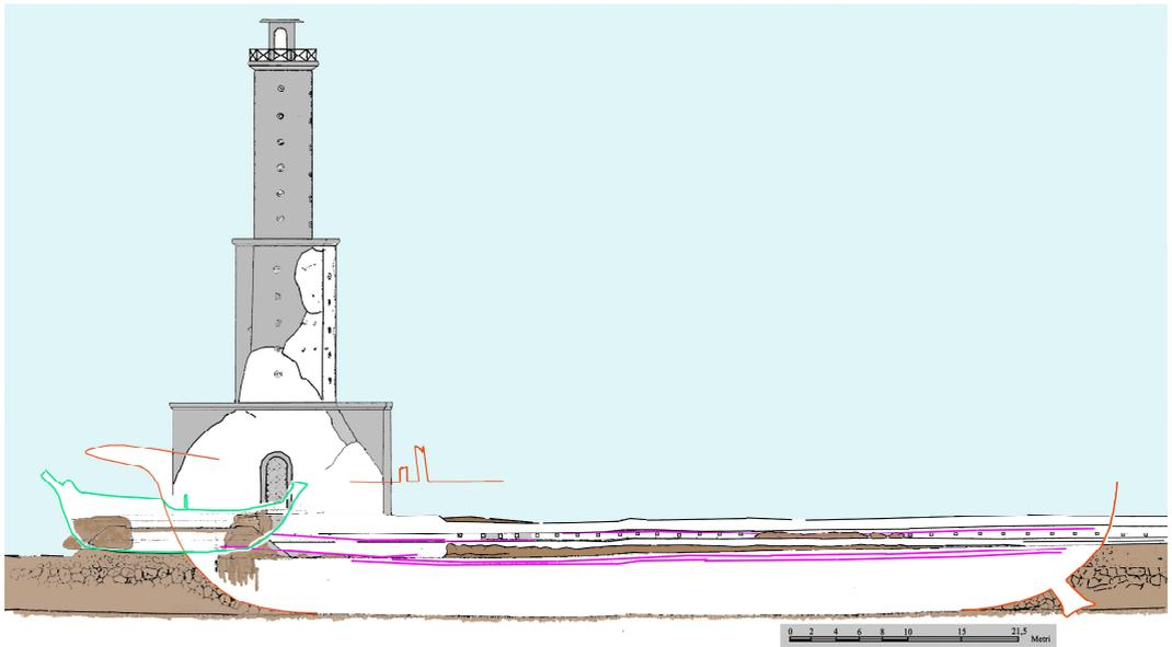
**fig. 38** Ipotesi ricostruttiva della sagoma della nave da carico impiegata per il trasporto dell'obelisco da Alessandria a Roma per volere dell'imperatore Caligola. Il perimetro (in verde) di una nave oneraria di circa 20 mt. fa apprezzare l'enorme differenza tra essa e la grande nave da trasporto (rappresentazione schematica da O. Testaguzza, ridisegnata a cura degli Autori).
